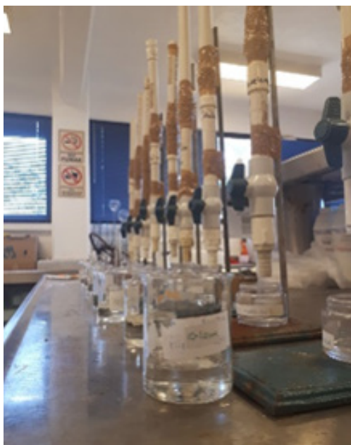
Figura 4. Detalle de las extensiones de PVC adaptadas a los tubos de resina para realizar la extracción.
