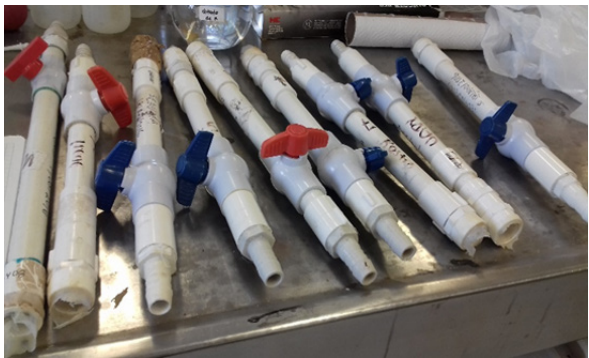
Figura 1. Detalle de la válvula que permite el drenado de la columna en los muestreadores RII.
