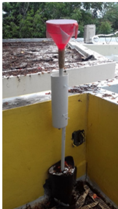
Figura 3. Detalle del ensamble del dispositivo de muestreo pasivo a base de RII.
