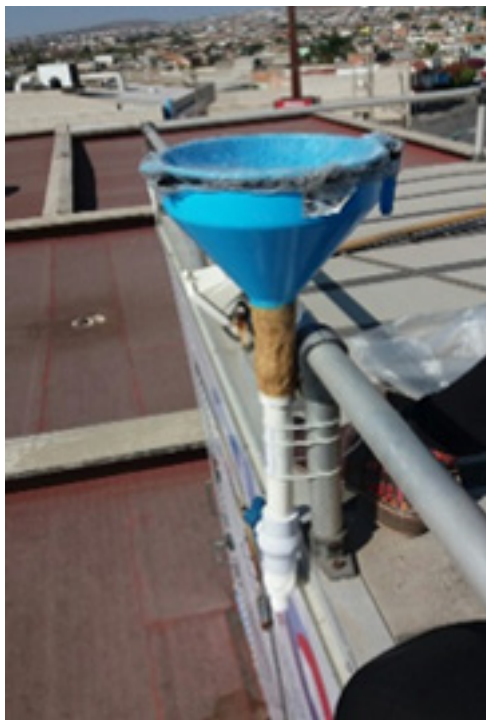
Figura 2. Detalle de cómo se lleva a cabo el drenado de la columna a través de la válvula.
