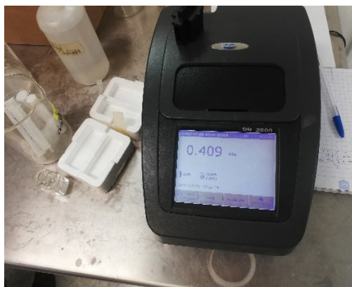
Figura 8. Lectura de absorbancias para determinar \text{SO}_4^{2-} .
