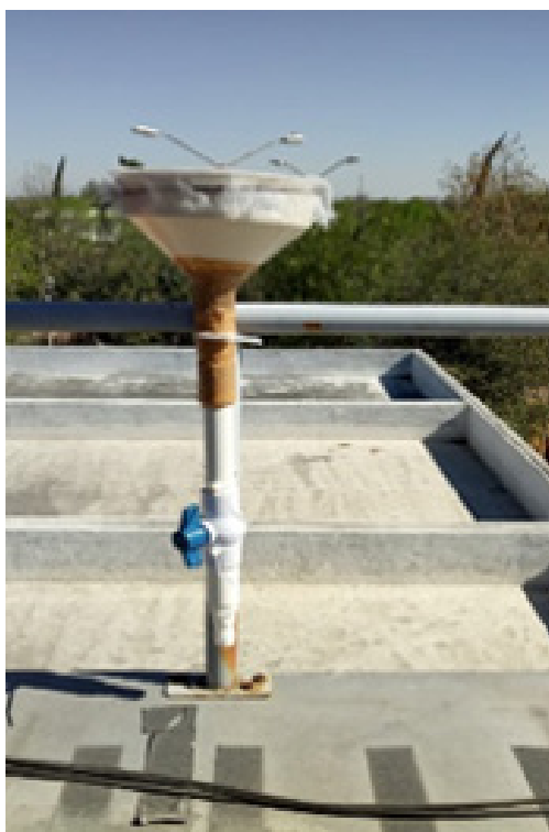
Figura 5. Dispositivo de muestreo pasivo o tipo throughfall para la colección de depósito atmosférico.
